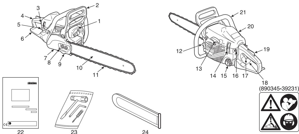
1. **Marmitta** - Controlla la rumorosità dello scarico e impedisce la fuoriuscita di particelle di carbone calde e incandescenti.
