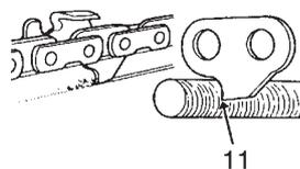
Una volta completata la regolazione della catena, immergerla in olio ed eliminare eventuali residui di limatura prima dell'uso.
