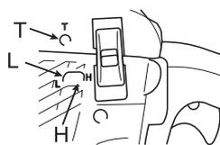
L: Vite di regolazione miscela bassa velocità
